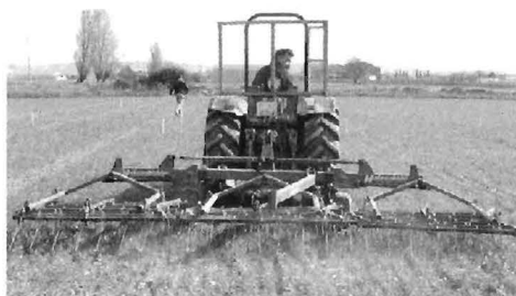
Figura nº 2: Foto y esquema de los cuerpos de la grada en adaptación a la superficie del suelo.
